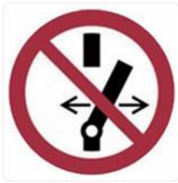
스위치의 상태를 바꾸지 마시오 Don't change the position of the switch
